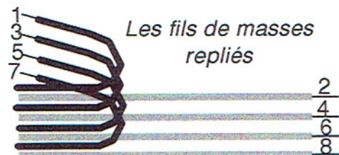
Séparation des fils par paquets de dix puis fil par fil
